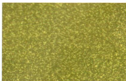
ПБВ с добавкой «Амдор-20Т» через 3,5 часа приготовления
