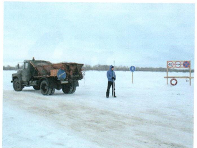
Фото 11. Испытания: измерение прогибов ледяной плиты под нагрузкой и сравнение показателей на армированном и неармированных участках
