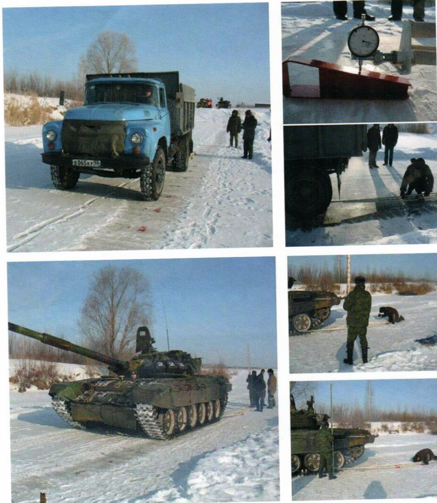
Фото 5. Испытание опытного участка колесной и гусеничной техникой
