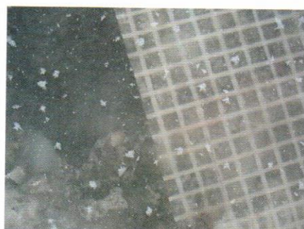
Фото 3. Армирующий геосинтетический материал, вмёрзший в лед снизу и сверху
