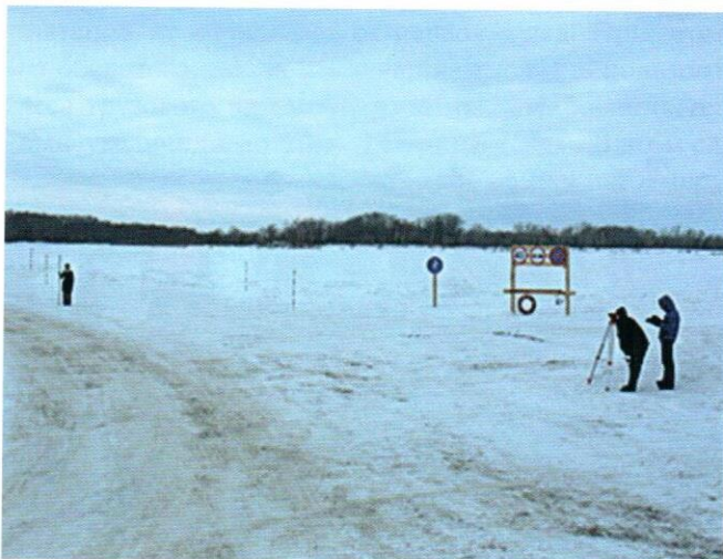
Фото 11. Испытания: измерение прогибов ледяной плиты под нагрузкой и сравнение показателей на армированном и неармированных участках
