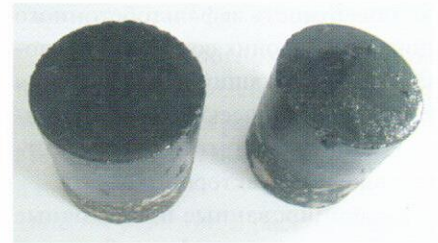
Фото 2. Образцы для испытания на истираемость резиновыми шинами на круге ЛКИ-3, обработанные пропиткой ASP с торцевой стороны
