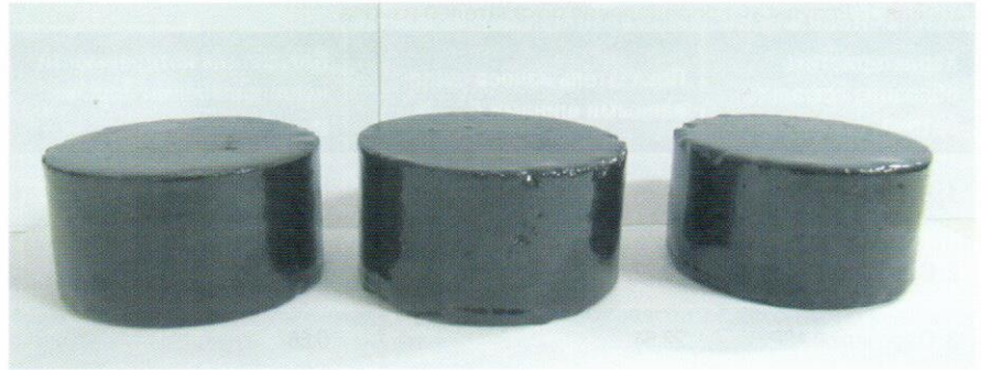
Фото 1. Образцы для испытания на износ шипами по методике АШМ, покрытые пропиточным составом ASP со всех сторон
