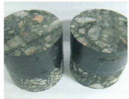
Фото 4. Общий вид образцов, обработанных пропиткой ASP, после испытания на истираемость на круге ЛКИ-3
