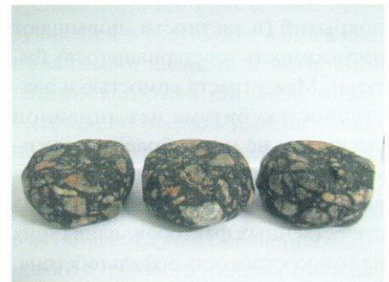
Фото 3. Общий вид образцов (пропитка ASP) после испытания на износ в шаровой мельнице
